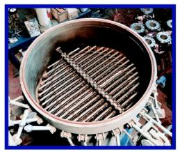
La foto, mostra un filtro a foglia verticale per una pressione di esercizio di 40 bar, utilizzato nella filtrazione a precoat di MEA. È chiaramente visibile il sistema di bloccaggio delle foglie ed il vibratore per lo scarico del pannello.
