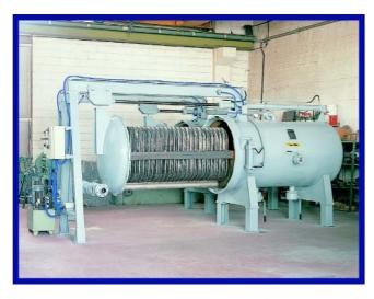
La foto a lato mostra un filtro a foglia orizzontale in cui sono chiara-mente visibili la centralina idraulica per la traslazione del pacco filtrante e l'apertura della chiusura rapida.
